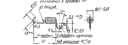
ПРУЖИНА СТЯЖНАЯ ПЕРВИЧНОЙ КОЛОДКИ Проволока стальная пружинная «Л1» маркан 2 ГОСТ 3389-60
